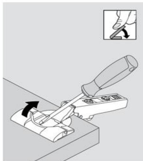
4. Hinge eemaldamiseks ukse küljest tõstke klipsi, seejärel tõstke kruvikeeraja abil hing üles.
