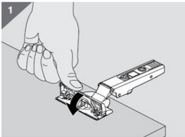
1. Suruge hinge klips lahti uksehinge puurimiseks ja seejärel vajutage klips kinni. Hing lukustub ukse külge.
