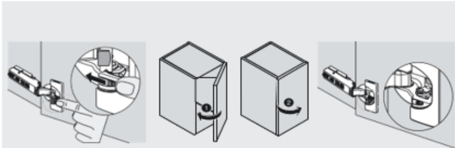
1. Hinge pidurdusmehhanismi saate välja lülitada väikese halli lüliti abil. Pöörake lüliti ja keerake hing suletud asendisse. Kostab kerge "kriipiv" heli ja pidurdus on tühistatud.
